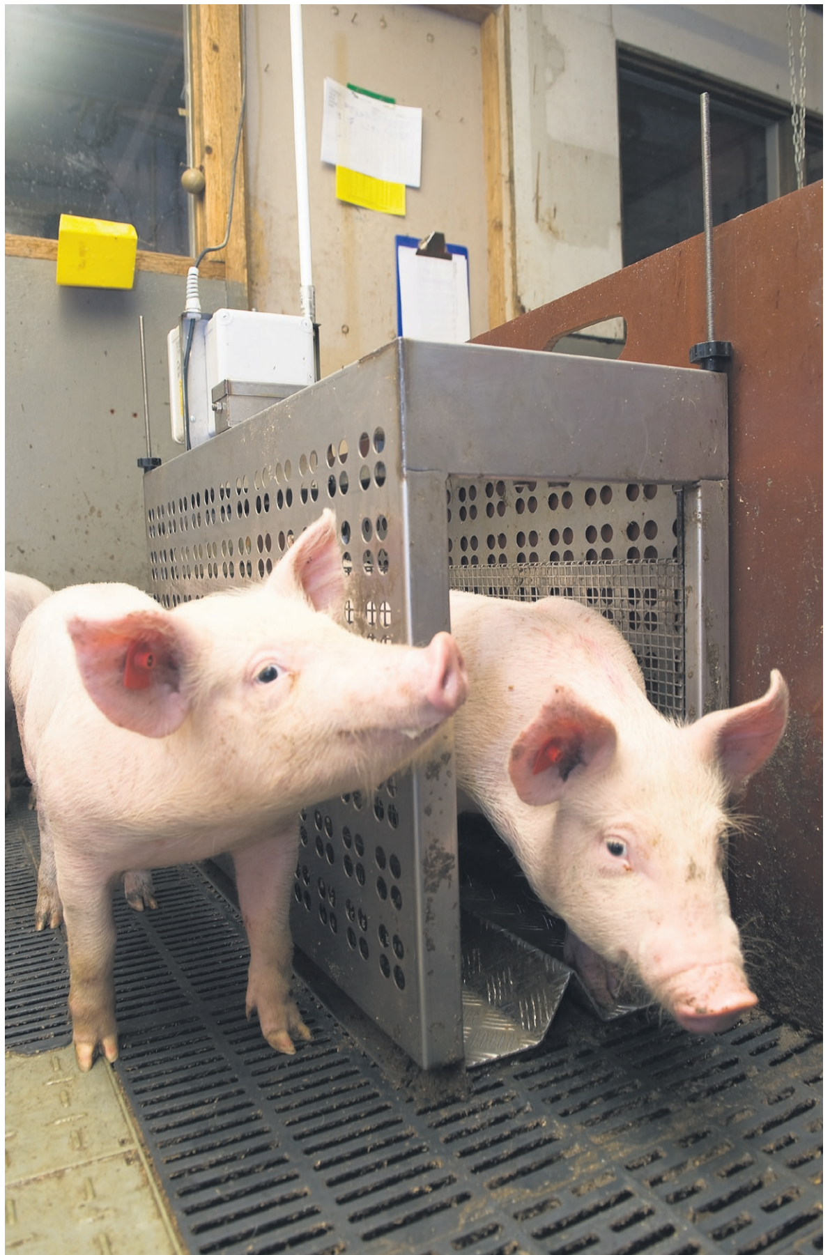
BIGGENWEGER – H&F Electronics uit Venlo brengt de eerste automatische biggenweeger op de markt. De weegschaal is in Nederland op drie bedrijven in gebruik waaronder op het Praktijkcentrum Sterksel. De reacties van de varkenshouders zijn volgens de producent positief, voor het eerst is er meer bekend dan alleen het start- en eindgewicht. Het is een vrijstaande weegschaal die de biggen zelfstandig betreden. Doordat de Pigscale slechts 25 kg weegt, is hij gemakkelijk te verplaatsen. Door het wegen is de dagelijks groei van biggen te volgen. Zo kunnen rantsoen en medicatie op basis van gewicht en leeftijd worden bepaald. Foto: Ingrid Zieverink
